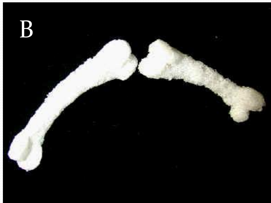
圖二 以溶劑融合鹽洗法所製備之多孔隙材料經裁切可製備為不同形狀如耳朵(a)或骨骼(b)之不同組織之外觀
