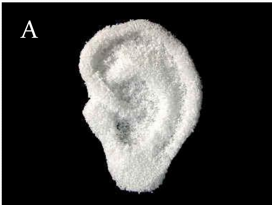
圖二 以溶劑融合鹽洗法所製備之多孔隙材料經裁切可製備為不同形狀如耳朵(a)或骨骼(b)之不同組織之外觀
